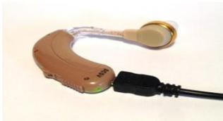
4 Durante la carga la luz se pondrá **VERDE**, cargar mínimo 3 horas para una carga completa
